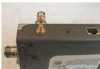
DWL-900AP+ met standaard RP-SMA bus. Erachter een RP-TNC bus ter vergelijking. Links een zelf gemonteerde female-N chassisdeel.
